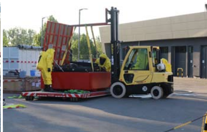
links: Mit seinem WLF brachte die WF Mercedes-Benz einen Batterie-Bergebehälter. rechts: Mittels Gabelstapler wurde die havarierte Batterie mitsamt dem Trägergestell in den Bergebehälter eingebracht.
