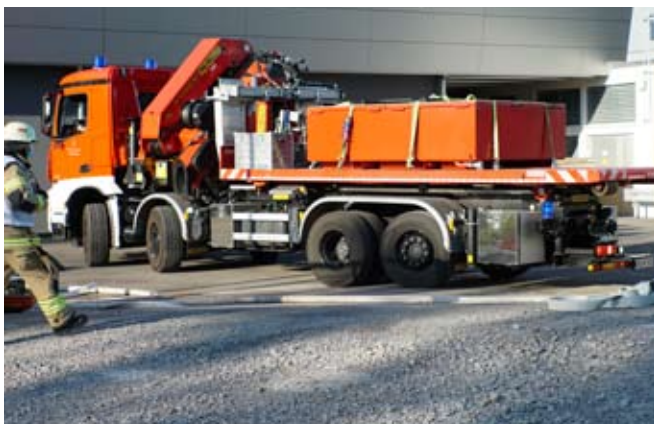
links: Mit seinem WLF brachte die WF Mercedes-Benz einen Batterie-Bergebehälter. rechts: Mittels Gabelstapler wurde die havarierte Batterie mitsamt dem Trägergestell in den Bergebehälter eingebracht.
