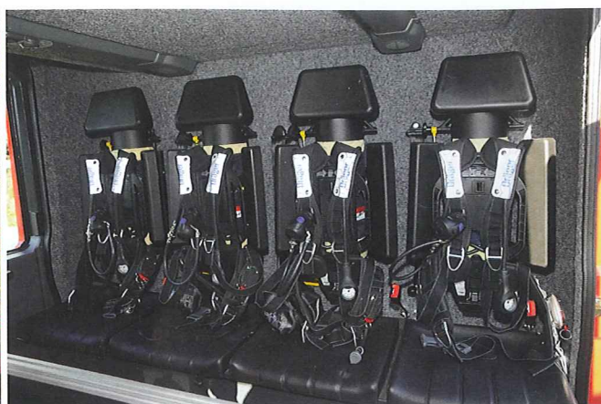
links: Im Geräteraum G1 werden u. a. ein akkubetriebener Kombispreizer und Verkehrswarngerät mitgeführt. rechts: Die vier Pressluftatmer sind im Mannschaftsraum in Fahrtrichtung verlastet.
