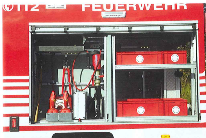
links: Im Geräteraum G1 werden u. a. ein akkubetriebener Kombispreizer und Verkehrswarngerät mitgeführt. rechts: Die vier Pressluftatmer sind im Mannschaftsraum in Fahrtrichtung verlastet.
