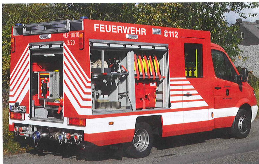
Der abgesetzte Pumpenbedienstand ist im Geräteraum GR angeordnet.
