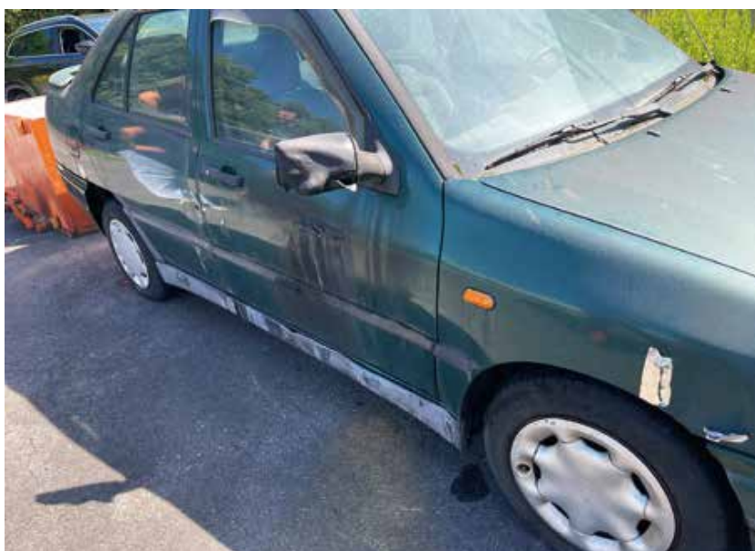
Dieser Pkw war bei einem Brandversuch in einem spanischen Testzentrum neben dem brennenden Fahrzeug abgestellt.
