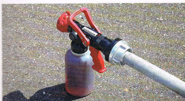
links: Hohlstrahlrohr mit F-500-Behälter beim Test 2 rechts: Zumischung des Firesorb-Gels am Z2R-Zumischer beim Test 3
