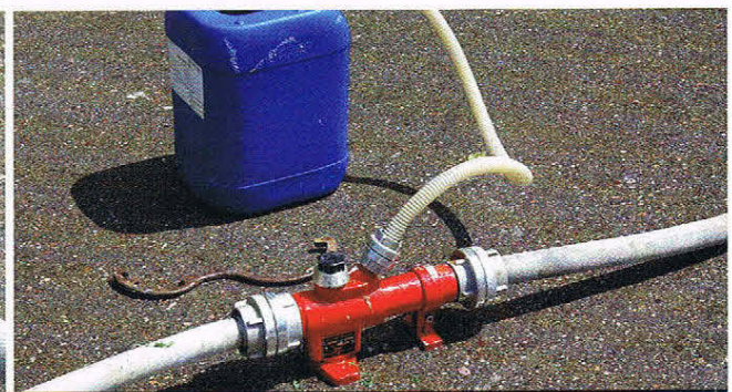
links: Hohlstrahlrohr mit F-500-Behälter beim Test 2 rechts: Zumischung des Firesorb-Gels am Z2R-Zumischer beim Test 3
