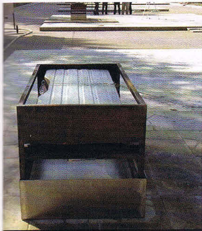
Lagerung der Lithium-Ionen-Batterie im Versuchsgestell. Darunter wurde das Stützfeuer gezündet.
