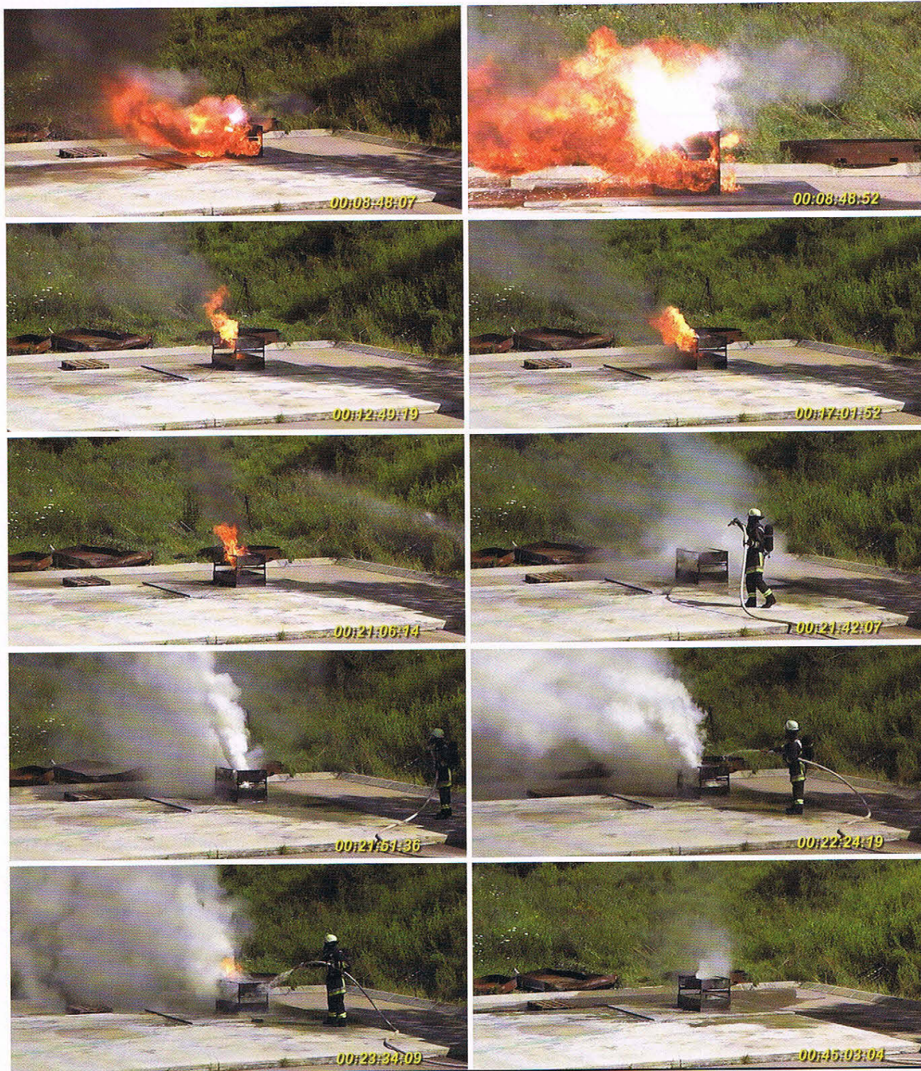
Test 1, Löschmittel Wasser: Nach 8:48 Minuten zeigt die Dokumentation einen Kurzschluss der Zellen mit einer Brandausbreitung. Der Lithium-Ionen-Akku brennt ab Minute 12 konstant mit nur kleinen Abweichungen in der Intensität. In Minute 21 beginnt die Brandbekämpfung mit der Folge der starken weißen Rauchentwicklung. Rückzündung in Minute 23. In Minute 45 ist nur noch eine leichte Rauchentwicklung festzustellen.
