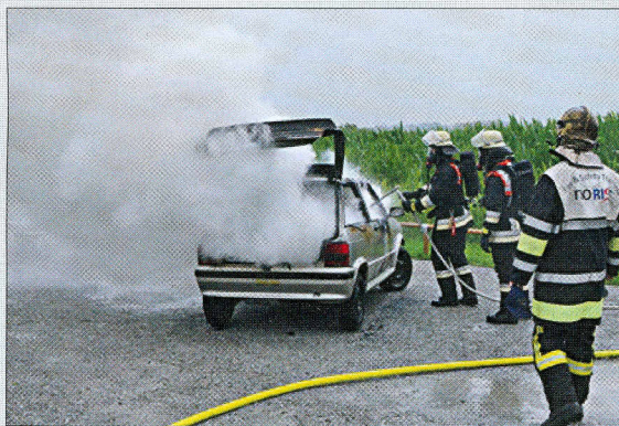
Löschtest: Der Trupp näherte sich mit dem Fognail dem brennenden Fahrzeug und steckte die Lanze danach einfach in das Fahrzeug.
