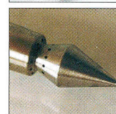
Löschlanze/ Fognail: Bei den Lösversuchen wurde dieser Fognail zur Brandbekämpfung mit Weit- und mit Breitsprühkopf eingesetzt.
